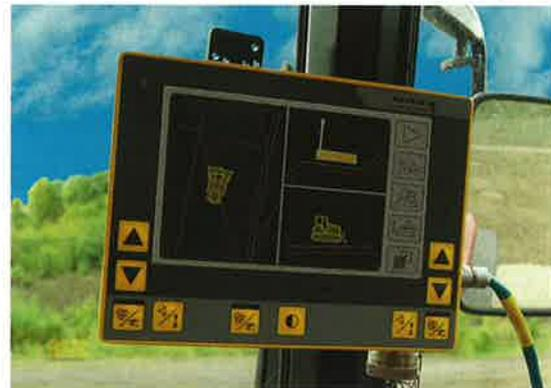
Einen optimalen Überblick bietet die Bedieneinheit des 3D Nivelliersystems Moba 3D-matic.
