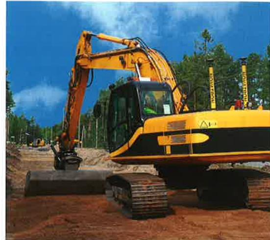
Ausgestattet mit dem Baggersystem Xsite Professional können 3D Modelle problemlos im Gelände umgesetzt werden.
